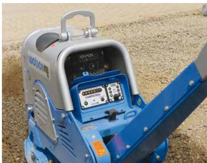
5. Il sistema Compatrol CCD 2.0 con la protezione del motore MDM integrata: verifica del livello di compattazione visualizzato sulla scala LED del display
