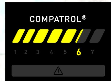
Come il precedente, ma con delle barre al posto dei pallini, che si riempiono gradualmente fino a fermarsi, una volta raggiunto il massimo grado di compattazione.
